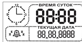
Нажатием кнопки ВХОД можно войти в меню управления будильником. Когда будильник включен, при его срабатывании раздается звуковой сигнал длительностью 60 секунд. Выключение звукового сигнала будильника нажатием любой кнопки. Кнопка ВХОД производит выбор корректируемого параметра (часы, минуты, режим вкл/выкл), кнопками ВВЕРХ ВНИЗ задается нужное время или вкл./выкл. режима. Выход - нажатием на кнопку ВЫХОД или НЕ нажатием ни на одну кнопку в течение 5...10 сек.
