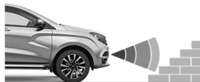
Излучатели установлены слишком высоко.
