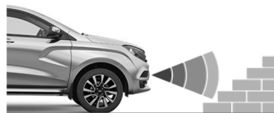
Излучатели установлены слишком высоко.
